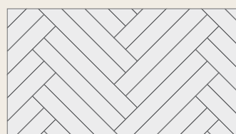
Doppelfischgrät mit nolte Design DMS - rechte und linke Stäbe je zur Hälfte - einheitliche Stablänge 490, 350 mm oder 600 mm
